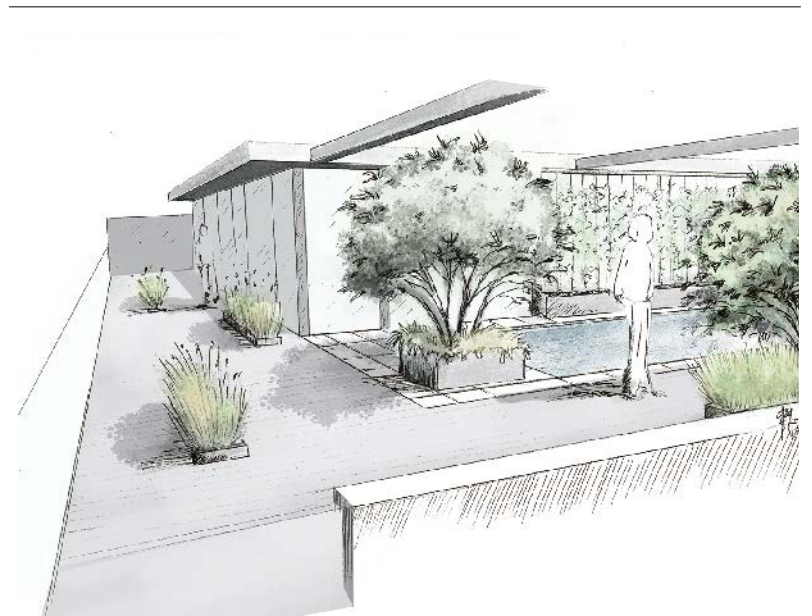
Planté d'ifs taillés, le long bac en bois vient masquer le parapet.
